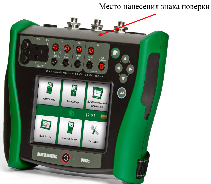
Рисунок 1 – Общий вид калибратора BEAMEX MC6 (-R) с указанием места нанесения знака поверки
