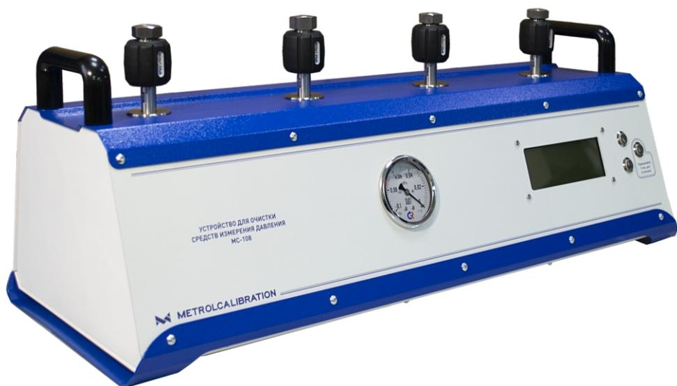
Устройство для очистки СИ давления МС-108 предназначено для автоматической очистки средств измерения давления (внутренняя полость чувствительного элемента) от остатков измеряемой среды путем обработки моющими растворами. Возможно подключение двух емкостей для моющего раствора и промывочной жидкости. Количество и длительность циклов очистки регулируется пользователем.
