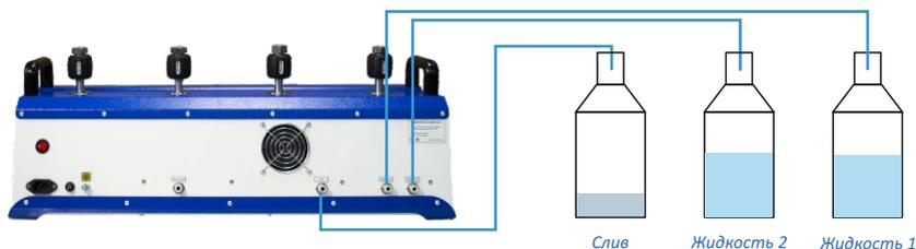
Рисунок 3 – Соединение устройства с ёмкостями
