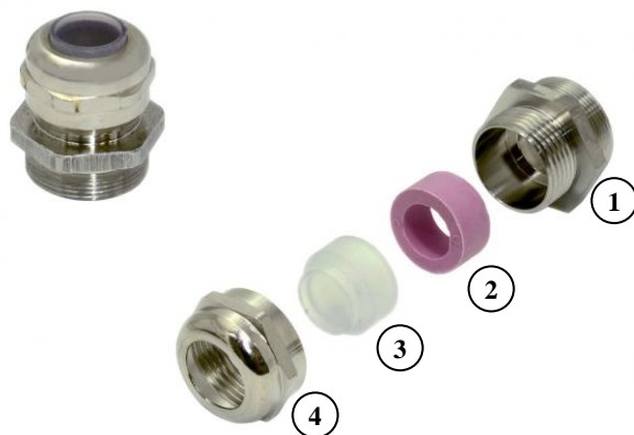
Рисунок 6 – Переходная втулка для установки гигрометра в измерительную камеру. 1 – прижимная гайка установочной резьбой M24×1, 2 – уплотняющее кольцо, 3 – толкатель, 4 – накидная гайка.
