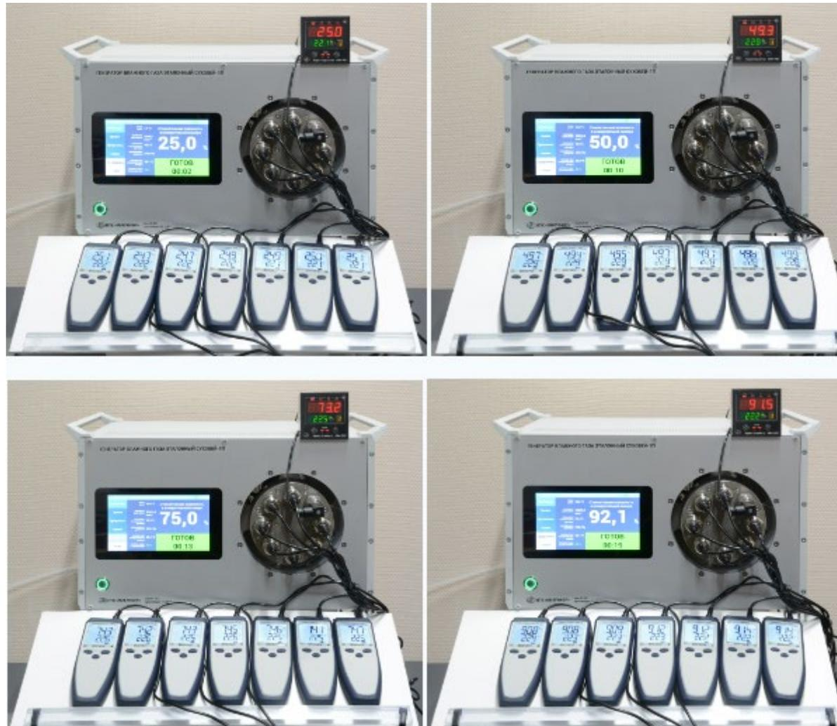
Рисунок 10 - Воспроизведение остальных значений относительной влажности в соответствии с методикой поверки.
