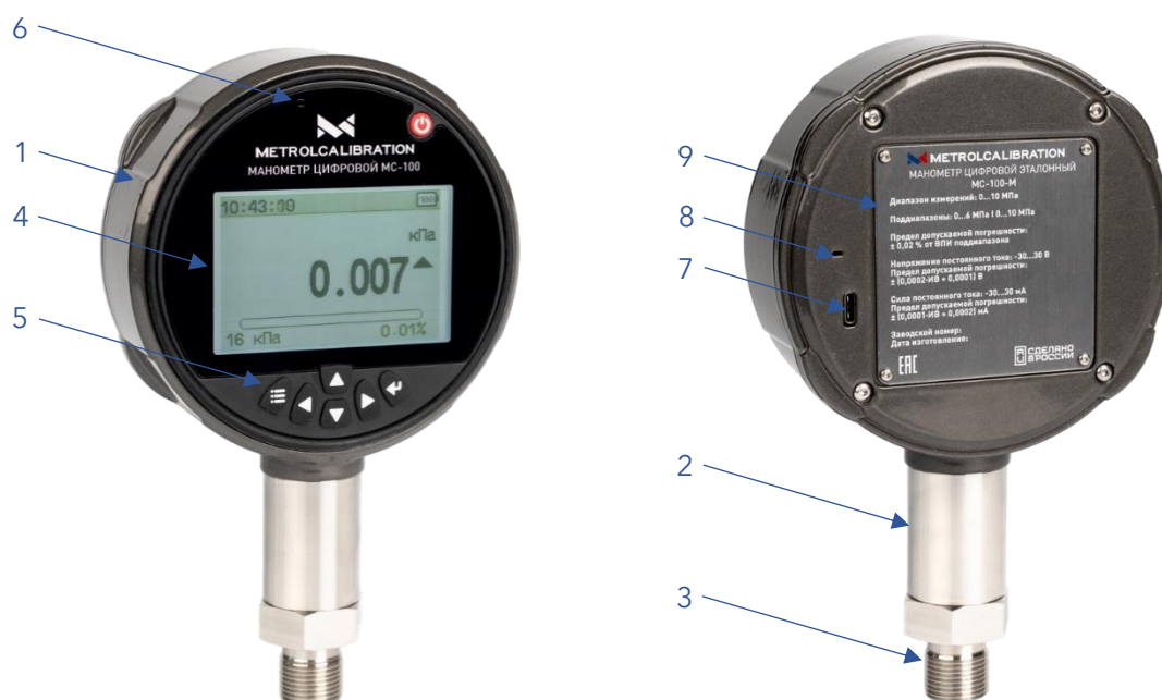
1- корпус; 2- чувствительный элемент; 3- штуцер для подключения к источнику давления; 4- жидкокристаллический дисплей; 5- кнопки управления; 6- светодиодный индикатор; 7- интерфейсный разъём для подключения к ПК; 8- динамик; 9- крышка батарейного отсека;
