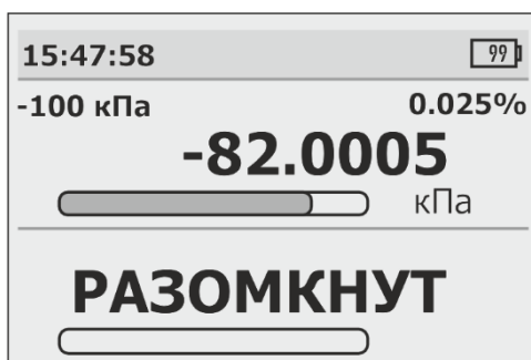
Р и с у н о к 8 – Внешний вид дисплея в режиме измерения давления и отслеживания состояния электрического контакта.
