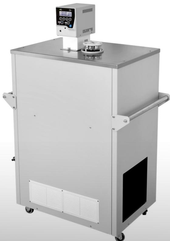
Переливной жидкостный низкотемпературный термостат ТЕРМОТЕСТ-05 предназначен для поддержания заданной температуры при поверке и калибровке различных термометров и датчиков температуры.
