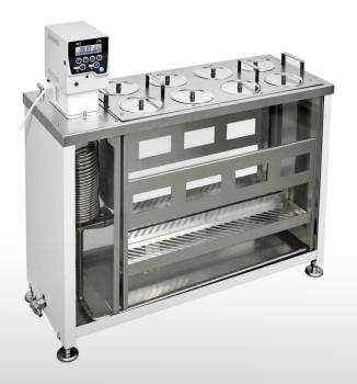
Жидкостный термостат с прозрачными стенками ВТ-ро-05 предназначен дляподдержания заданной температуры при поверке стеклянных ареометров непосредственным сличением в соответствии с Р 50.2.041.
