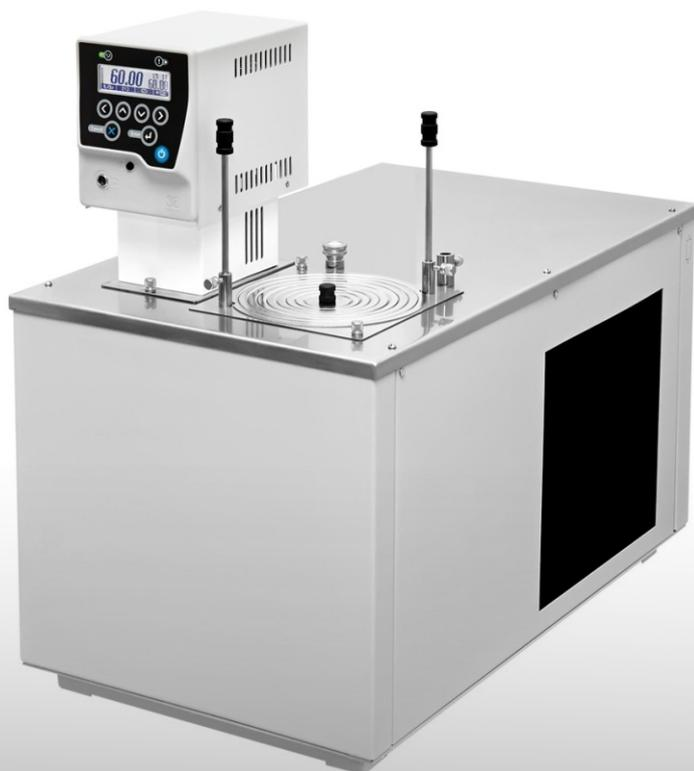
Жидкостный низкотемпературный термостат КРИО-МТ-08 предназначен для термостатирования ячеек при поверке стеклянных электродов и электродов сравнения, рН-метров, кондуктометров, анализаторов кислорода, а также для поддержания заданной температуры при приготовлении поверочных и буферных растворов, определения их метрологических характеристик в соответствии с требованиями ГОСТ Р 8.857, ГОСТ Р 8.754, ГОСТ Р 8.722, ГОСТ 8.292, ГОСТ 8.135, Р 50.2.036, Р 50.2.035, Р 50.2.033.
