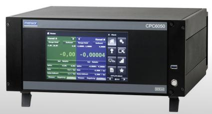
Калибратор давления Модели СРС6000, являясь модульным изделием, в зависимости от исполнения подходит под широкие варианты задач. Калибратор может иметь до 2-х независимых каналов, работающих независимо друг от друга, в каждом из которых может находится до 2-х образцовых датчиков. Калибратор также может иметь исполнение с встроенным барометром, с расширенной неопределенности 0,01% ИВ.
