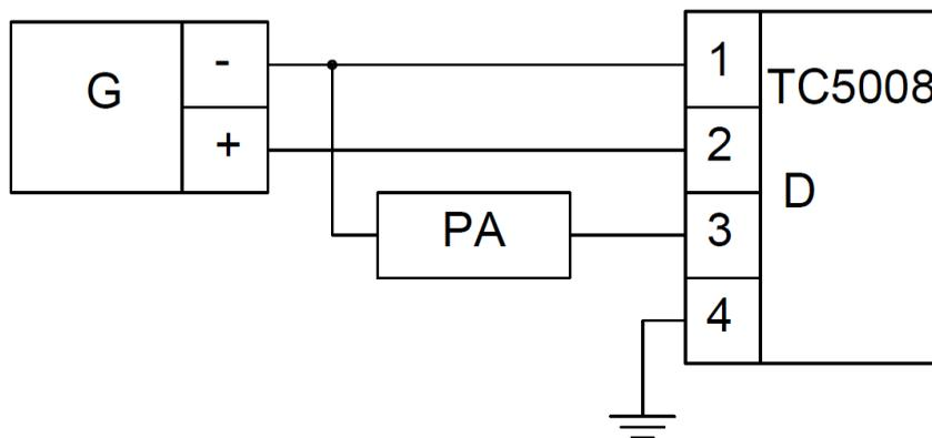
G-источник питания; D- датчик; РА-миллиамперметр
