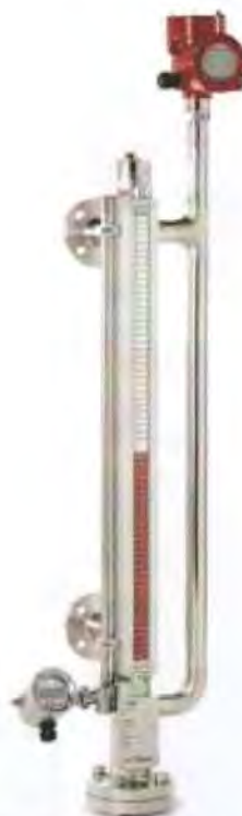
Рисунок 3 – Общий вид уровнемеров моделей BNA-SD (DUPlus), BNA-HD (DUPlus) (исполнение с магнитострикционным датчиком на первой байпасной камере и контактным микроволновым датчиком на второй байпасной камере)
