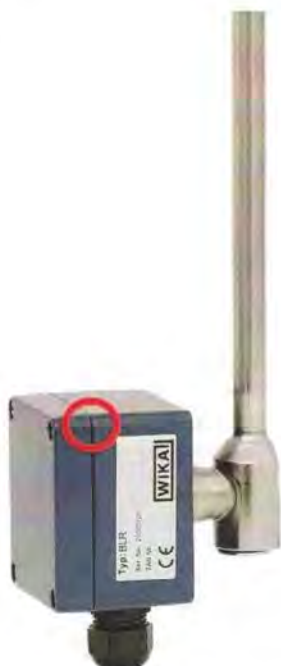
Рисунок 6 – Место нанесения на корпуса датчиков BLR пломбы поверителя
